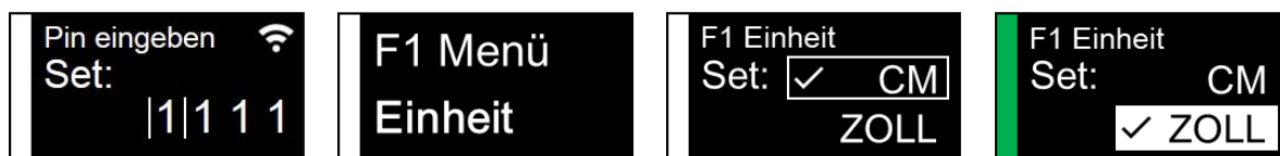
Abbildung 6: nach Angabe des korrekten Pins öffnet sich das Menü (Beispiel der Einheitseinstellung)
